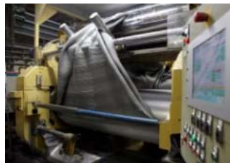
nora systems_Schritt 1_Mischkammer_2
