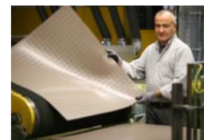
nora systems_Schritt 5_Endbearbeitung norament_2
